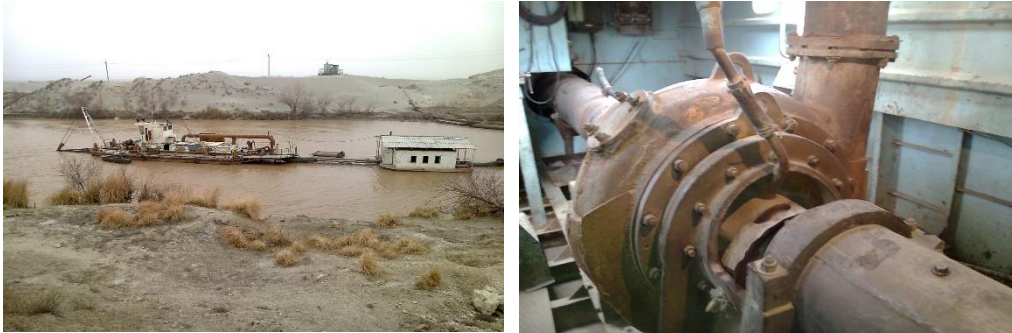
Рис.1 - Грунтовый насос -8-19 на Каршинском канале.
