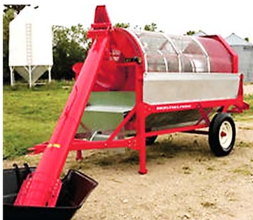
2 сурет: Қолданымдағы жылжымалы құрылымды қосбарабанды сұрыптағыш: а) фотокөрінісі; б) принциптік нобайы [4]
