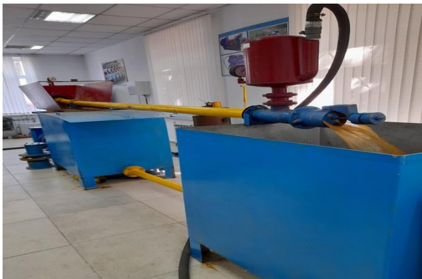
Рисунок 4.4 – Общий вид стенда для проведения экспериментальных исследований и лабораторных испытаний гидротаранной насосной установки
