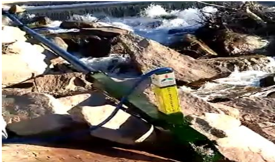
Рисунке 4.2 - Общий вид экспериментального образца гидроударной насосной установки для орошения земель, расположенных в зонах водотоков
