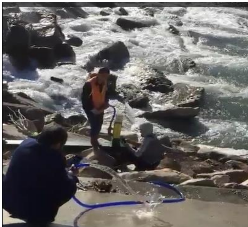
Рисунок 4.18 – Фрагмент испытаний экспериментального образца усовершенствованной гидротаранной насосной для орошения земель в зонах водотоков в натуральных условиях
